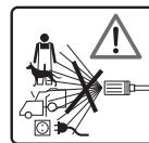
Les nettoyeurs à haute pression peuvent être dangereux en cas d'utilisation impropre. Le jet ne doit pas être dirigé vers des personnes, des animaux, des équipements électriques activés ou l'appareil lui-même.
