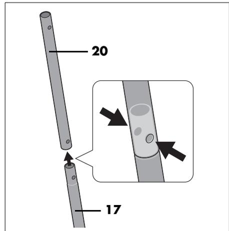
1. Lange Stange **17** in kurze Stange **20**. Bohrungen liegen genau übereinander.
