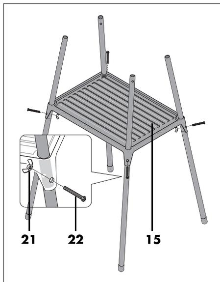
3. Nožičky nasuňte cez odkladaciu plochu **15**. Vložte vždy jednu skrutku **22** a upevnite krídlovými maticami **21**.
