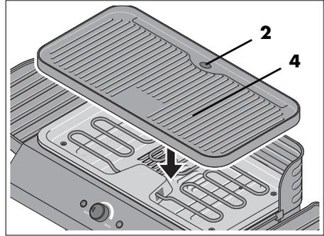
8. Grillplatte **4** auf das Basisgerät **9** setzen und den Fettauffangbehälter **6** einsetzen.
