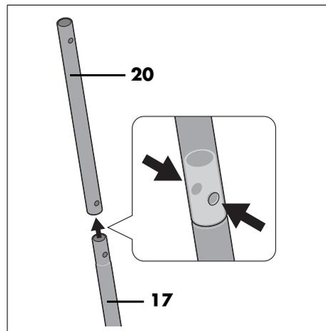
1. Varilla larga **17** en varilla corta **20**. Los orificios coinciden exactamente.
