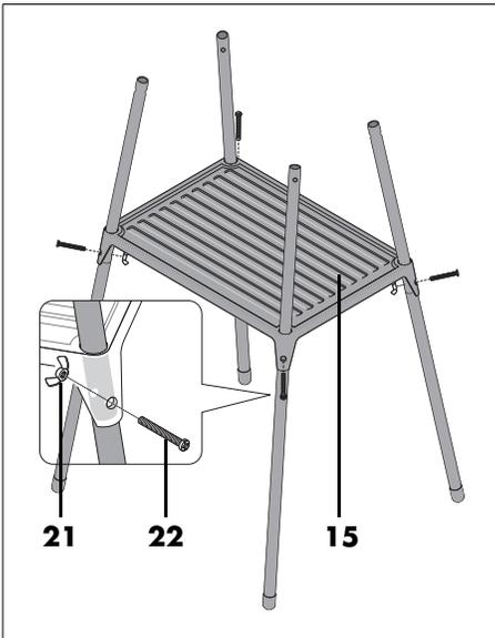
3. Empujar las patas por la superficie de colocación **15**. Colocar un tornillo **22**, respectivamente, y fijar con las tuercas de mariposa **21**.
