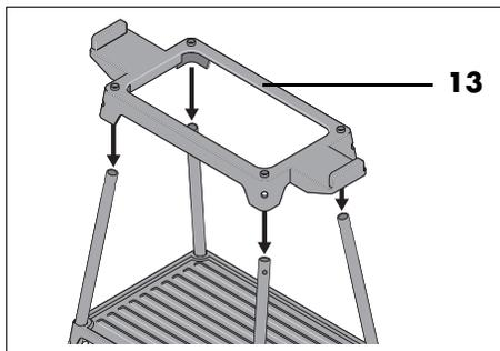
4. Założyć ramę **13** i zamocować ją za pomocą śrub **22** i nakrętek motylkowych **21**.
