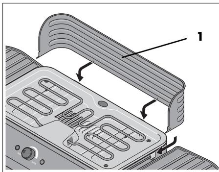
7. Założyć osłonę przeciwwietrzną **1** od tyłu na urządzenie podstawowe **9**.
