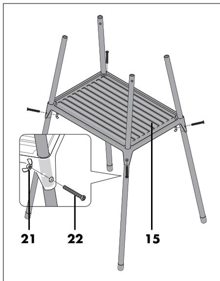
3. Passer les pieds par la surface de dépose **15**. Dans chacun, mettre en place une vis **22** et fixer avec les écrous papillons **21**.
