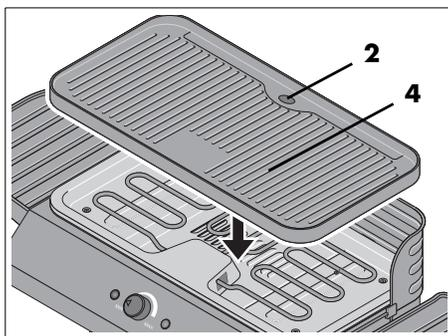
8. Położyć płytę grillową **4** na urządzeniu podstawowym **9** i włożyć pojemnik na tłuszcz **6**.
