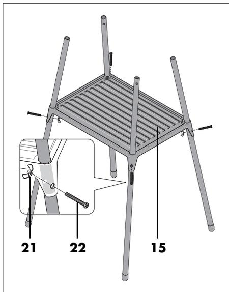
3. Wsunąć nogi do półki **15**. Włożyć po jednej śrubie **22** i zamocować je za pomocą nakrętek motylkowych **21**.
