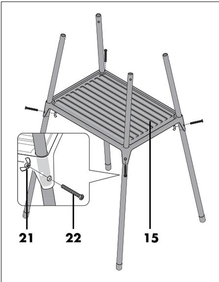
3. Schuif de poten door het plateau **15**. Plaats telkens één schroef **22** en bevestig deze met de vleugelmoe- ren **21**.
