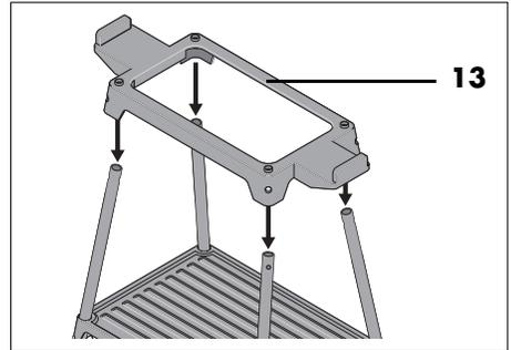
4. Colocar el bastidor **13** y fijar con tornillos **22** y tuercas de mariposa **21**.
