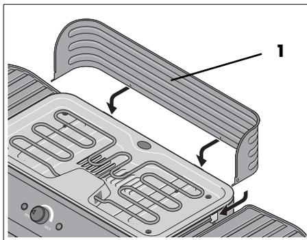
7. Mettez le pare-vent **1** en place sur la base de l'appareil **9** depuis l'arrière.
