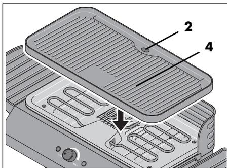
8. Placer la plaque de cuisson **4** sur la base de l'appareil **9** et mettre en place le récipient collecteur de graisse **6**.
