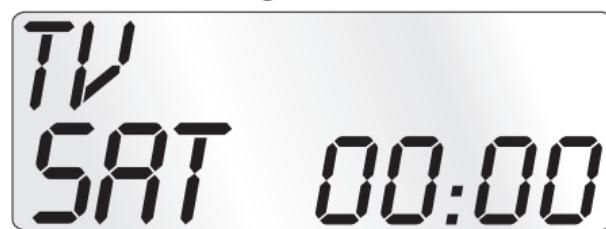
Die Standardanzeige der LCD-Anzeige ① besteht aus den Angaben für das aktuelle Gerät, z.B. „TV“, dem Kürzel für den Wochentag und der Uhrzeitanzeige.
