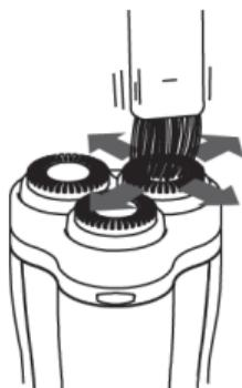
Nehmen Sie die Schutzkappe [1] ab. Reinigen Sie dann die Scherköpfe des Schersystems [2] mit dem beiliegendem Reinigungspinsel.
