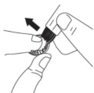
Irrota terä teräkotelosta. Puhdista terä tämän jälkeen varovaisesti toimitukseen sisältyväällä puhdistusharjalla.
