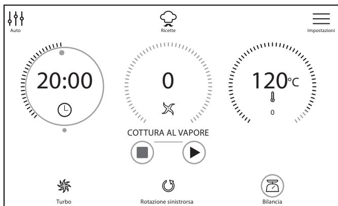
**NOTA:** è possibile modificare i valori del tempo. Toccare il regolatore dell'indicazione relativo al tempo ed eseguire l'impostazione direttamente con il regolatore dell'indicazione o con la manopola di regolazione.
